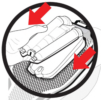
Abbildung 17: Entfernen des Airbags und aller elektronischen Komponenten von der Rückseite des Systems
