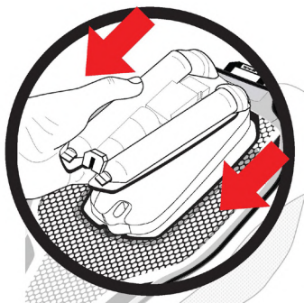
Figure 17 : Comment retirer l'airbag et tous les composants électroniques de l'arrière du système
