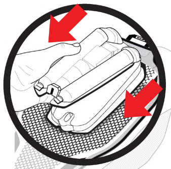
Afbeelding 17: De airbag en alle elektronische onderdelen verwijderen van de achterkant van het systeem
