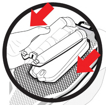
図17:エアバッグとすべての電子部品をシステムの背面から取り外す方法
