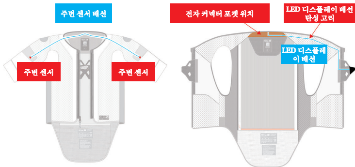
그림 15: 시스템 베이스 레이어의 전자 부품 위치(1);
