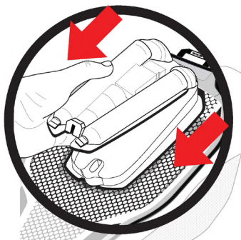
Figura 17: Cómo extraer el Airbag y todos los componentes electrónicos de la parte trasera del sistema
