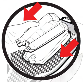
Figur 17: Sådan fjernes airbaggen og alle de elektroniske komponenter fra bagsiden af systemet
