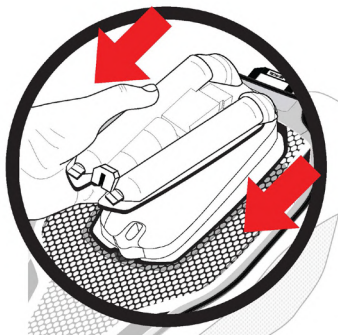
그림 17: 시스템 후면에서 에어백 및 모든 전자 부품을 제거하는 방법
