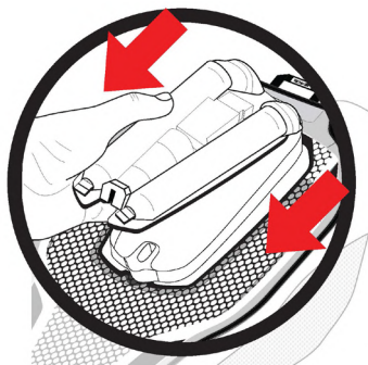
图 17: 如何从系统后部拆卸安全气囊和所有电子部件
