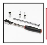
TOOLS: 1.) Ratchet 2.) 3/16" Allen Socket 3.) 5/32" Allen Socket 4.) Extension 5.) 7/16" Socket
