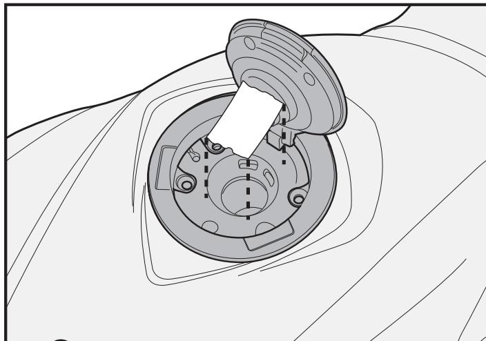
. PRIMA DI PROCEDERE APPLICARE DELLO SCOTCH SUL FORO DEL SERBATOIO PER EVITARE DI FARVI CADERE ACCIDENTALMENTE DELLE VITI.
