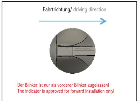
8) Das gelbe Kabel (Blinklicht) wird an Plus (+), das schwarze Kabel an Masse ( - ) angeschlossen. **Achtung: Nur an 12V DC Bordnetz anschließen! Bei Nichtbeachtung erlischt die Garantie!**
