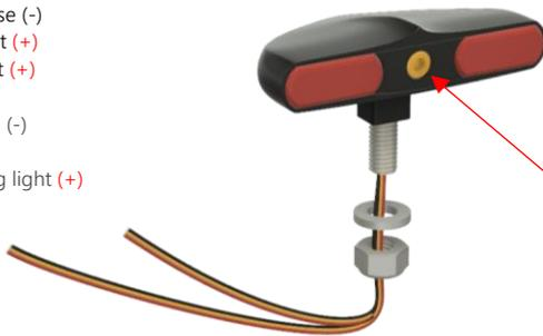
Durch lösen der M3 Innenvierkant Schraube kann der Winkel des Stieles um bis zu 30 Grad verstellt werden. Ziehen Sie die Schraube vorsichtig wieder an (handfest).
