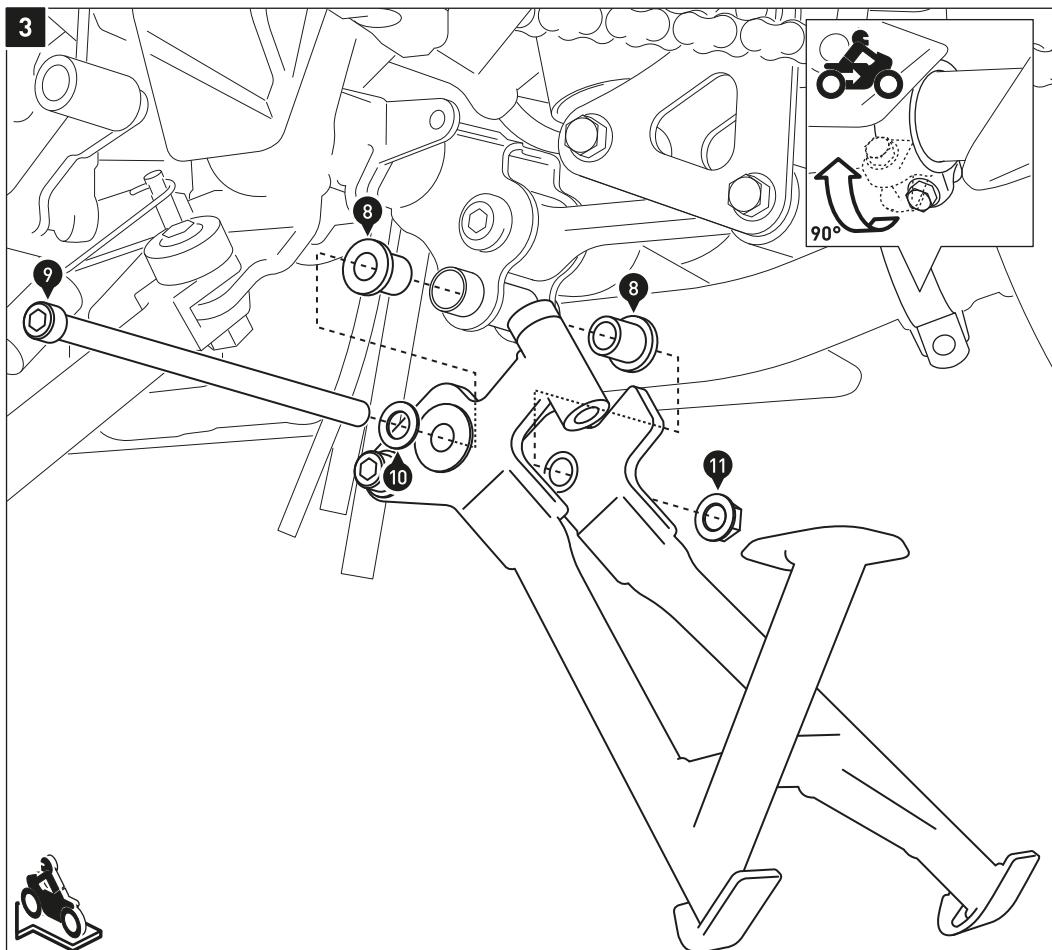
**ACHTUNG:** Lösen Sie rechtsseitig die gezeigte Auspuffschelle und drehen Sie diese um 90 Grad nach außen. Ziehen Sie anschließend die Schraube der Auspuffschelle wieder an.
