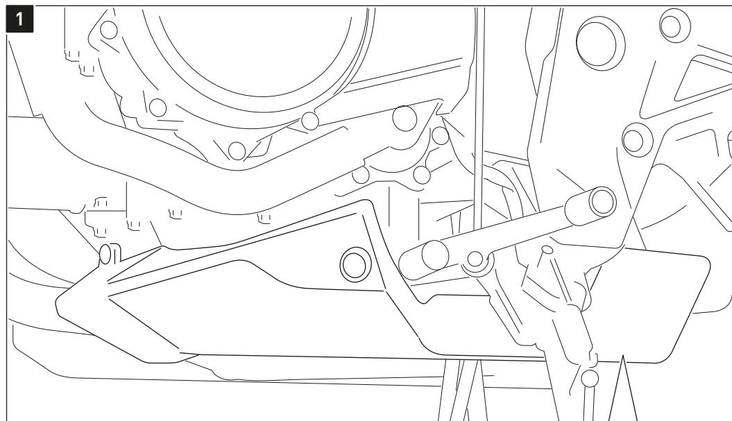
Vor Montage des Hauptständers muss eine Aussparung an der unteren (linken) Kunststoffverkleidung vorgenommen werden (HONDA CB 500 F gezeigt).
