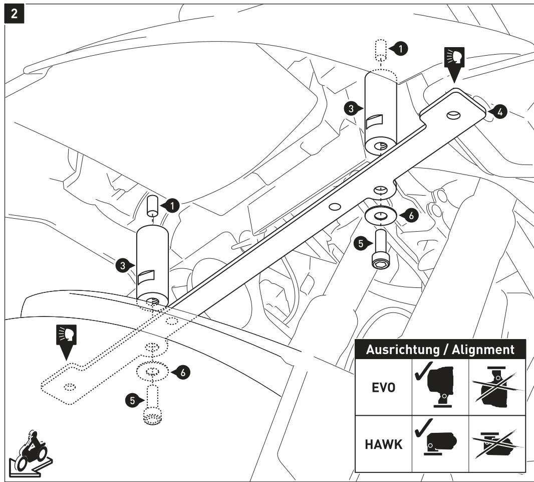
**HINWEIS:** Bei gleichzeitiger Verwendung dieses Scheinwerfer-Halters mit dem SW-MOTECH Sturzbügel, montieren Sie den Querverbinde (4) des Scheinwerfer-Halters anstelle den des Sturzbügels.
