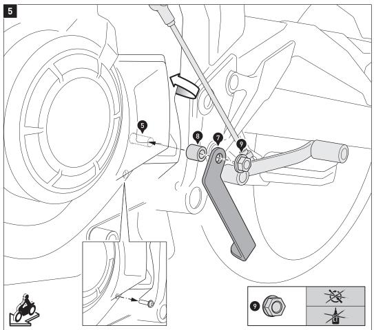
Entfernen Sie die gezeigte untere Schraube und ziehen Sie das Verkleidungsteil leicht nach vorn, um den Verbau der Komponenten zu erleichtern.
