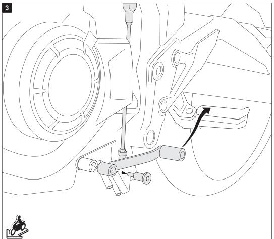
Lösen Sie die gezeigte Schraube und legen Sie den Schalthebel auf der Soziusfußraste ab.
