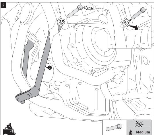
Entfernen Sie nun die in der Detail-zeichnung gezeigte Motorhalte-schraube und die Distanzbuchse auf der linken Fahrzeugseite.
