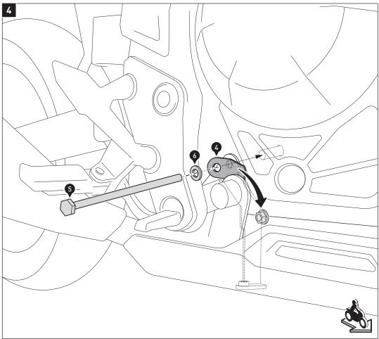
Entfernen Sie die Mutter auf der rechten Fahrzeugseite.
