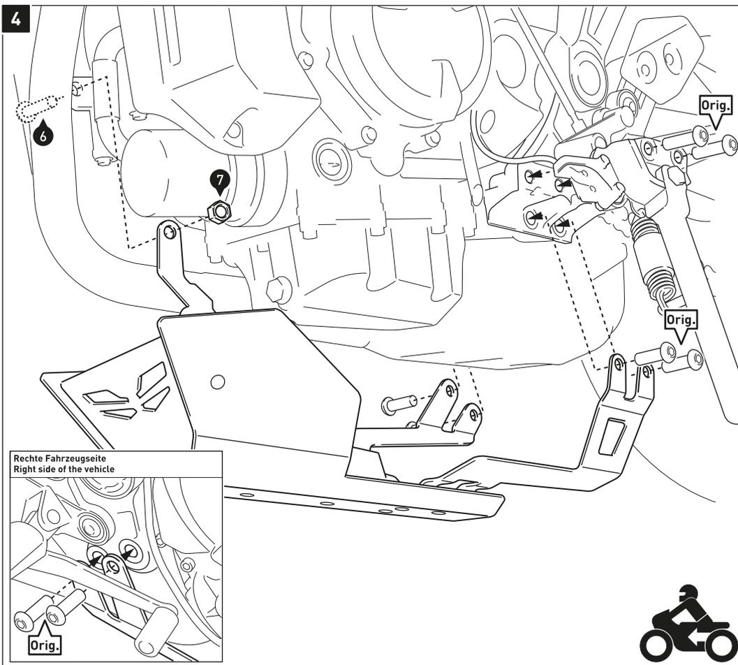
Verschrauben Sie den Bugspoiler mit Schraube (6) und den originalen Schrauben (Orig.) am Fahrzeug, wie in der Zeichnung gezeigt.
