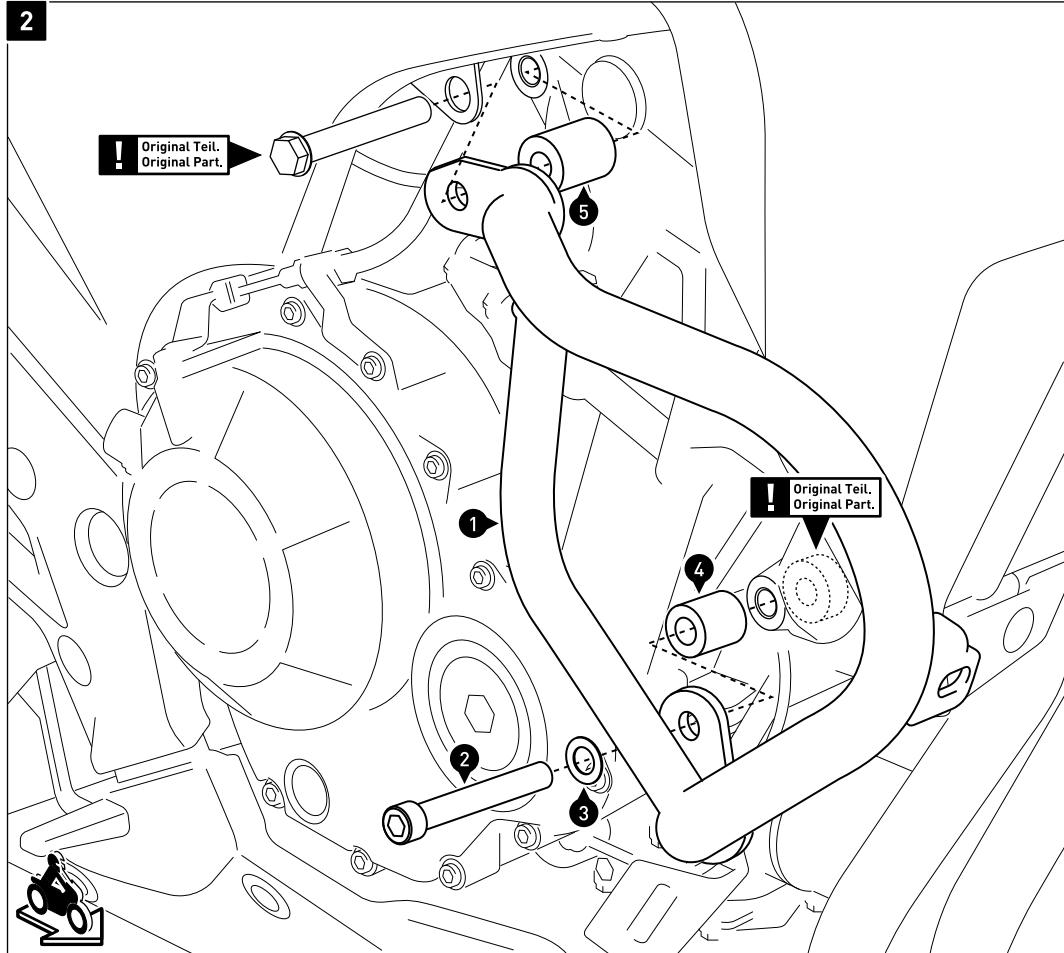
Verschrauben Sie die rechte Schutzbügelhälfte (1), wie in der Zeichnung gezeigt. Verwenden Sie am oberen Anbaupunkt die originale Schraube. **ACHTUNG: Verwenden Sie flüssige Schraubensicherung!** Ziehen Sie die Schrauben noch nicht an.
