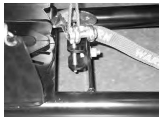
Figura 3 - Soporte del perno en J y cabrestante
