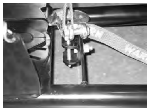
Figure 3 - Support du boulon en J et treuil
